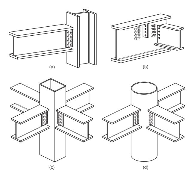
FIGURE 14. TYPICAL WEB SIDE PLATE CONNECTIONS
