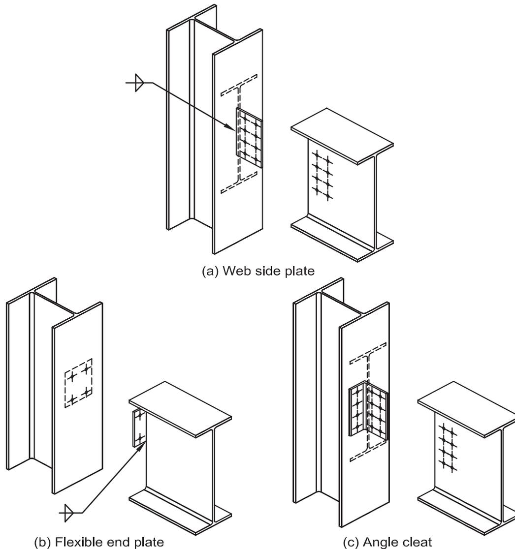
**FIGURE 1. SIMPLE CONNECTIONS**
